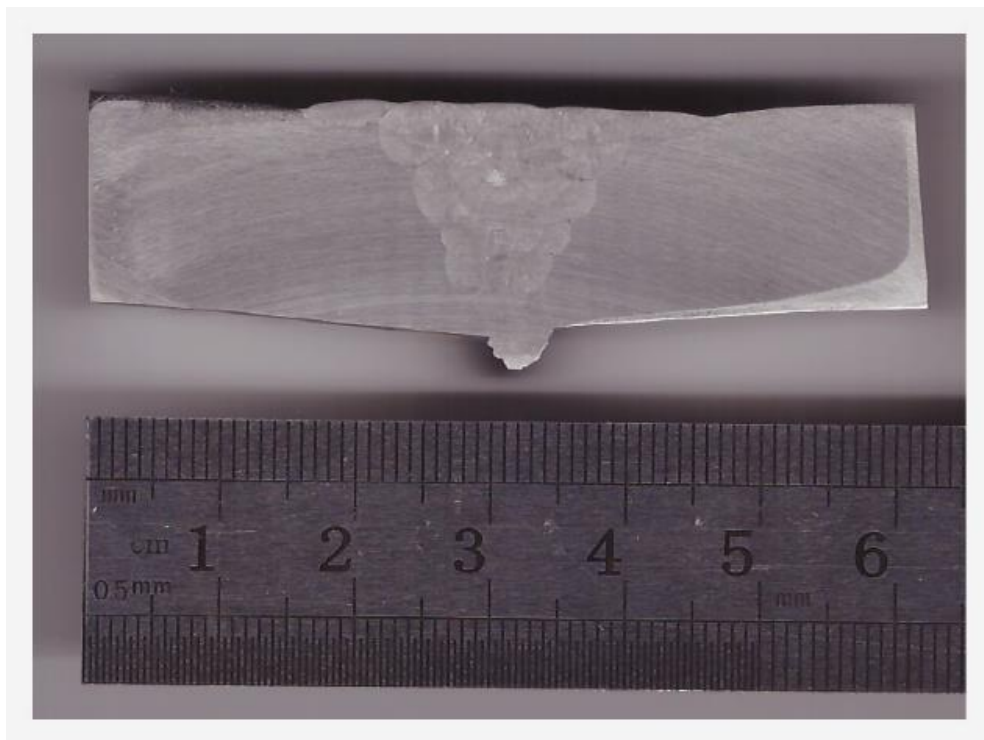
Figura 24: Macrografia da junta soldada. Ataque: Ácido oxálico 10%
